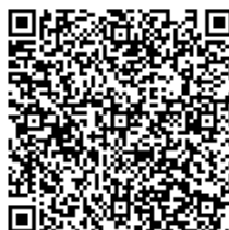
図 17—誤り訂正レベル M(15%) バージョン 24 (25mm×25mm 程度)
