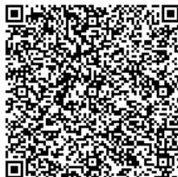
図 22—誤り訂正レベル Q(25%) バージョン 32 (32mm×32mm 程度)
