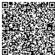
図 15—誤り訂正レベル H(30%) バージョン 28 （28mm×28mm 程度）
