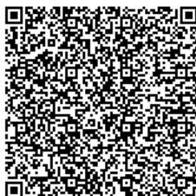
図 23—誤り訂正レベル H(30%) バージョン 36 (37mm×37mm 程度)
