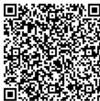
図 14—誤り訂正レベル Q(25%) バージョン 24 （25mm×25mm 程度）
