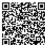
図 12—誤り訂正レベル L(7%)バージョン 18 （18mm×18mm 程度）
