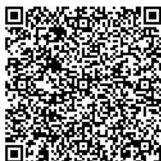
図 21—誤り訂正レベル M(15%) バージョン 28 (28mm×28mm 程度)
