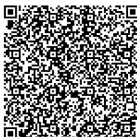
図 19—誤り訂正レベル H(30%) バージョン 32 (34mm×34mm 程度)
