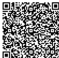
図 20—誤り訂正レベル L(7%)バージョン 24 (25mm×25mm 程度)
