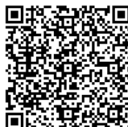
図 16—誤り訂正レベル L(7%)バージョン 22 (23mm×23mm 程度)
