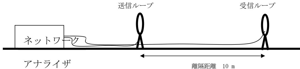
図A.1—グランドループ確認実験構成図
