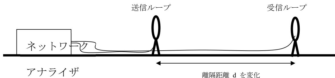
図A.4—放射源からの離隔距離減衰確認実験構成
