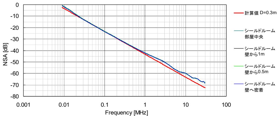
図 B.10—場所 シールドルーム, 離隔距離  $d=0.3\text{ m}$
