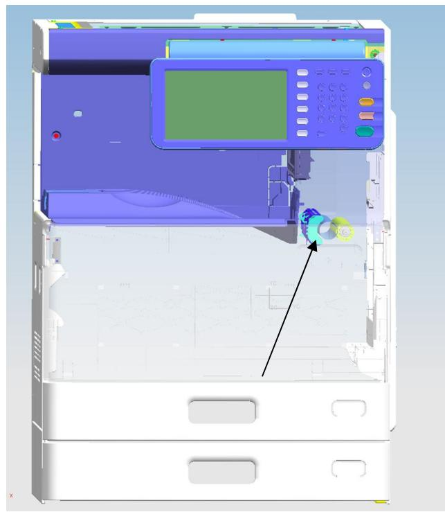
図3－コピー機の放射源の例（中央部右寄りの円筒状部分）
