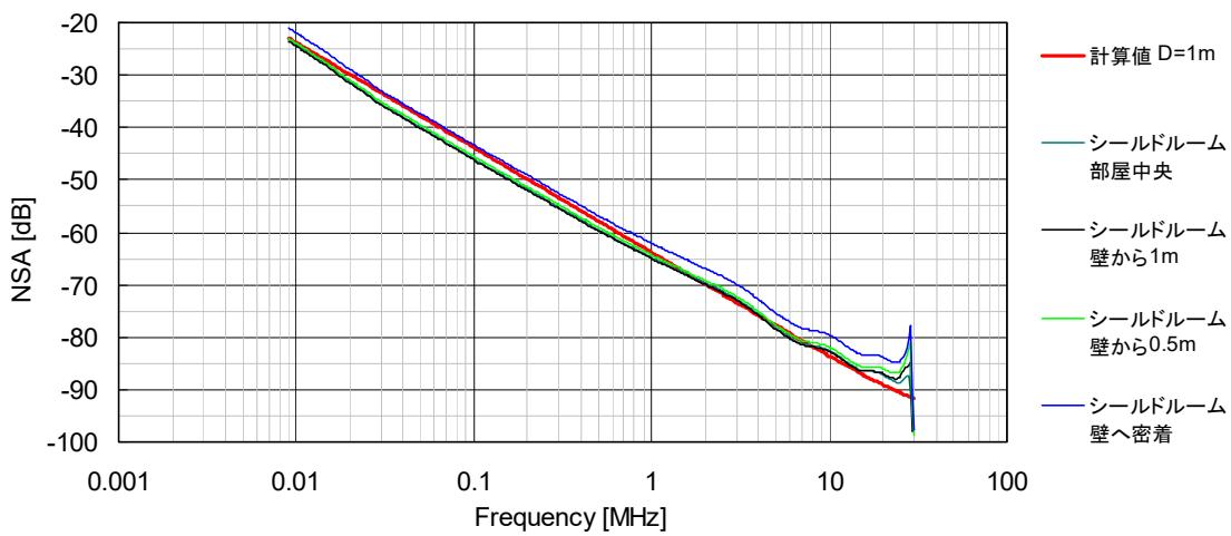
図 B.11—場所 シールドルーム, 離隔距離  $d=1.0\text{ m}$
