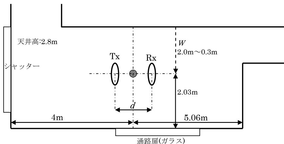
図 B.3—ロビーのアンテナ配置位置
