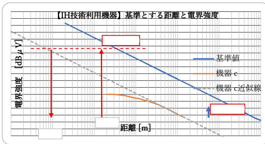
図1—IH利用機器より放射する放射特性（JBMIA-TR-25 図2より）
