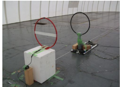
図A.5—離隔距離減衰確認実験写真
