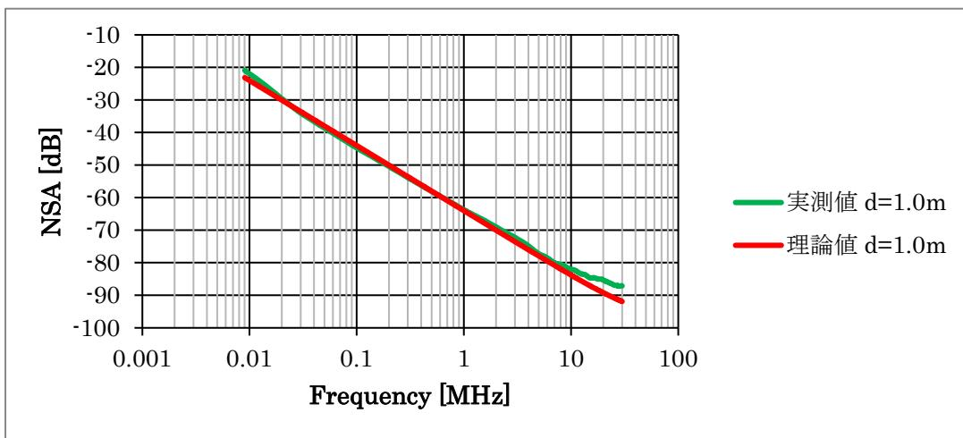
図B.24—場所 オープンサイト, 離隔距離 $d=1.0\text{ m}$
