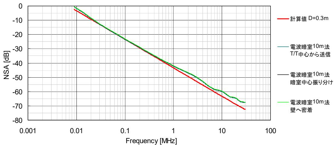
図 B.15—場所 電波暗室, 離隔距離  $d=0.3$  m
