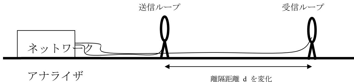
図A.7-放射源からの離隔距離減衰確認実験構成
