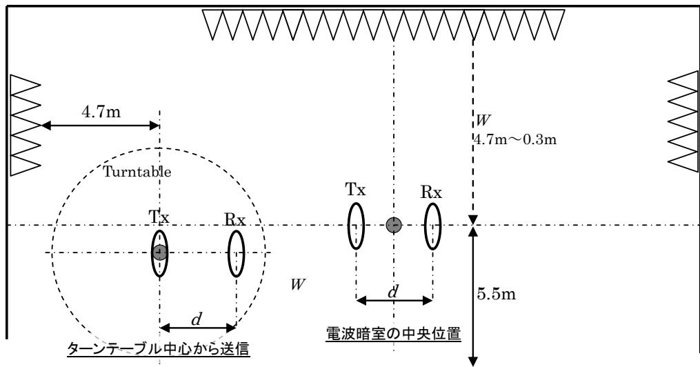
図B.13—電波暗室測定位置
