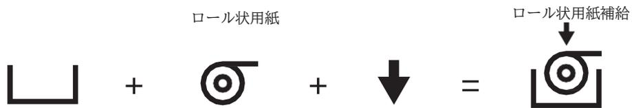
「ロール状用紙補給」は、容器を表わす図形と「ロール状用紙」及び補給を表わす容器の内側へ向けた矢印を合成した図記号である。
