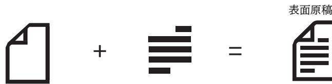
「表面原稿」は、原稿を表わす図形と、文章を表わす線分を合成した図記号である。
